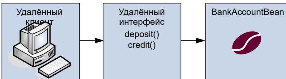
Рис. 35-1. Интерфейсы для Enterprise-бина с удалённым доступом
